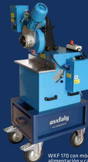
WKF 170 con módulo de alimentación y carro de transporte con recogedor de virutas
