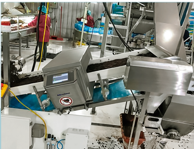
Montado sobre un sistema de motorización inclinado, el detector de metales es una solución que ahorra espacio
