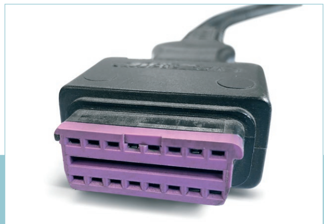
Ejemplo de conector macho (cada orificio en la superficie del conector macho es universal y precisa su propio núcleo)
