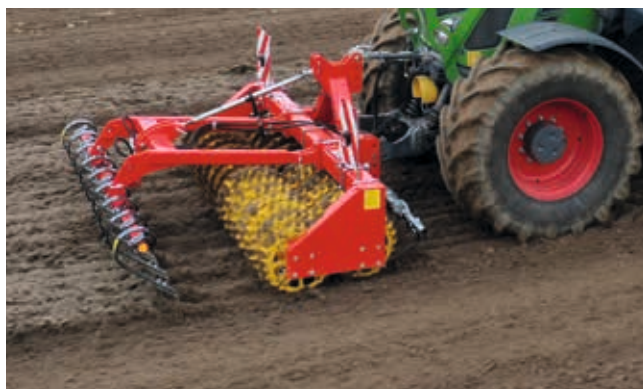
Die selbstreinigenden DUPLEX® Prismenwalze® gibt selbst schweren Tonböden eine lockere Krümelstruktur.
