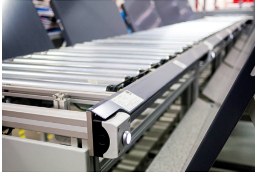
Der leuchtende Taster signalisiert, dass der Wagen abholbereit ist
