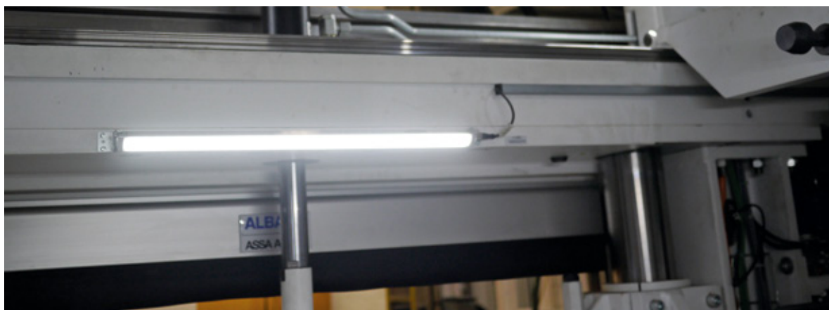
Die dimmbare LED-Maschinenleuchte WLS-28 aus dem Turck-Portfolio wird auch mit Standard-M12-Steckverbindern angeschlossen
