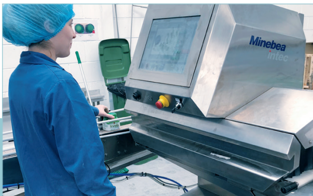
El sistema de inspección por rayos X detecta de manera fiable cuerpos extraños en el procesamiento de productos
