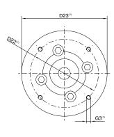
La representación corresponde a un HLAE070 / de una etapa / Eje de salida con chavetero / 11 mm Sistema de amarre / Ajuste del motor – 1 pieza / B5 Tipo de brida motor
