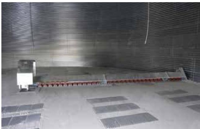
Las **barredoras** de Silos Spain se adaptan a todos nuestros diámetros de silo y pueden complementarse con accesorios que optimizan el vaciado eliminando todo residuo existente entre la barredora y el suelo. Cumple con la normativa ATEX para poder trabajar en el interior del silo.
