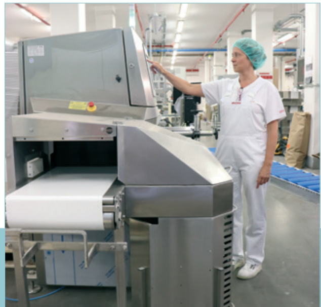
El sistema de inspección por rayos X Dymond se ha implementado como punto de control crítico en Anona al final de la línea de producción
