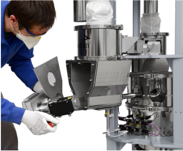
Panel posterior y salida de material/corredera desmontables
