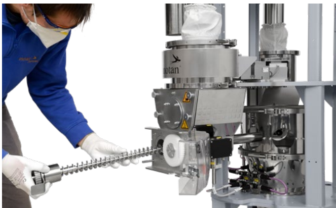
Sencilla sustitución de los dosificadores de tornillo sin fin y las cajas de cambio
