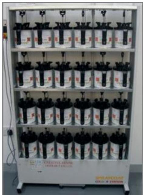
La estación consta de un mueble de jarras de 24 posiciones con agitado para evitar la sedimentación de las tintas cerámicas. Simplemente se coloca la lata de 2,5kg con su tapa dispensadora y estará listo para usar cuando se necesite.
