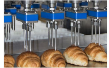
Triple boquilla inyectora para el relleno de croissants
