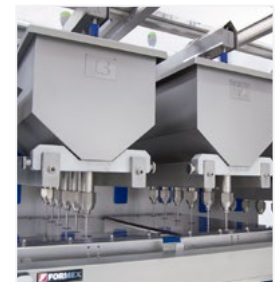
Doble depósito calefactado para relleno de dos sabores.
