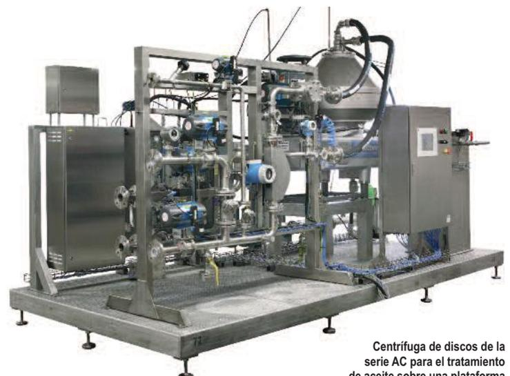
Centrifuga de discos de la serie AC para el tratamiento de aceite sobre una plataforma
