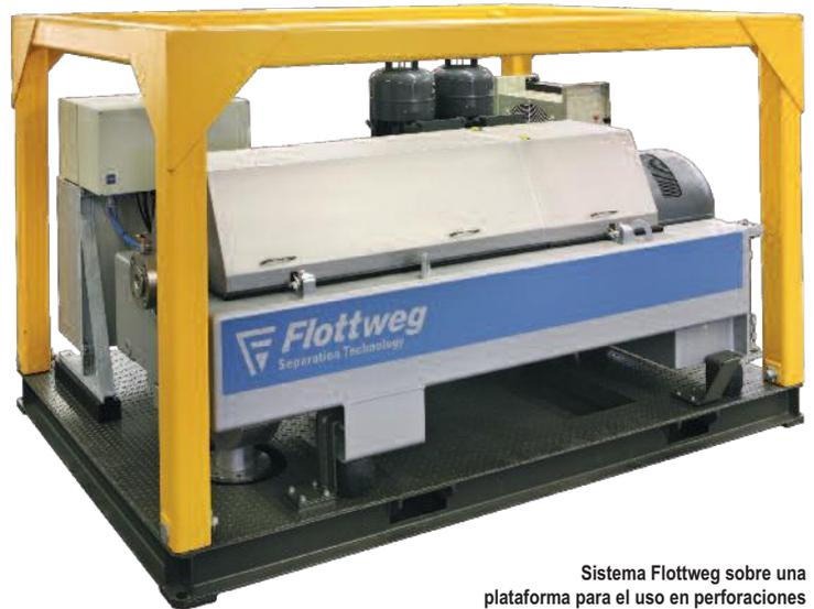
Sistema Flottweg sobre una plataforma para el uso en perforaciones
